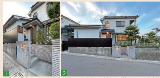
1 ▲増床部分やテラス・一部植栽を撤去して、ゆとりを持たせた外観ファサードと玄関アプローチ。玄関アプローチの土間は、滑り止めを兼ねて、左官洗い出し仕上げに 2 ▲雨戸の戸袋は木による造作
