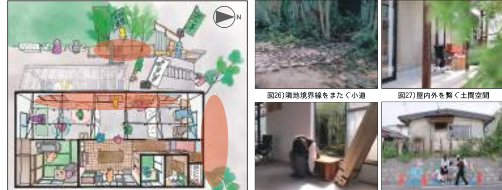
図25) 建築的デザインを行った各境界領域を赤丸で示した平面配置図 図26) 隣地境界線をまたぐ小道 図27) 屋内外を繋ぐ土間空間 図28) 窓際を人の居場所にする什器 図29) 子ども達と共創した擁壁
